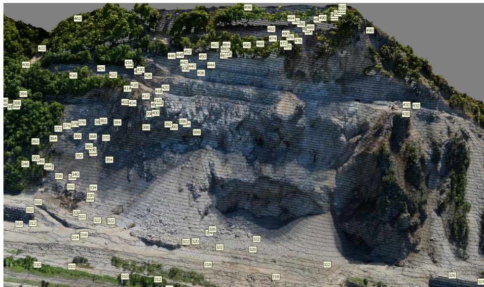
Slika 2. Georeferenciran 3D model sa prikazom izolinija terena
