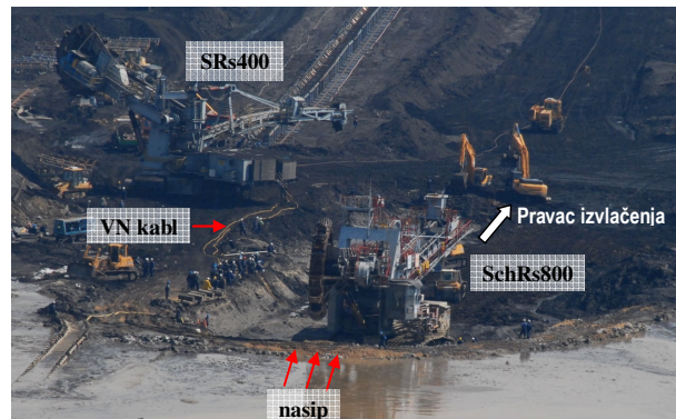
Слика 1. Принцип извлачења багера SchRs 800
